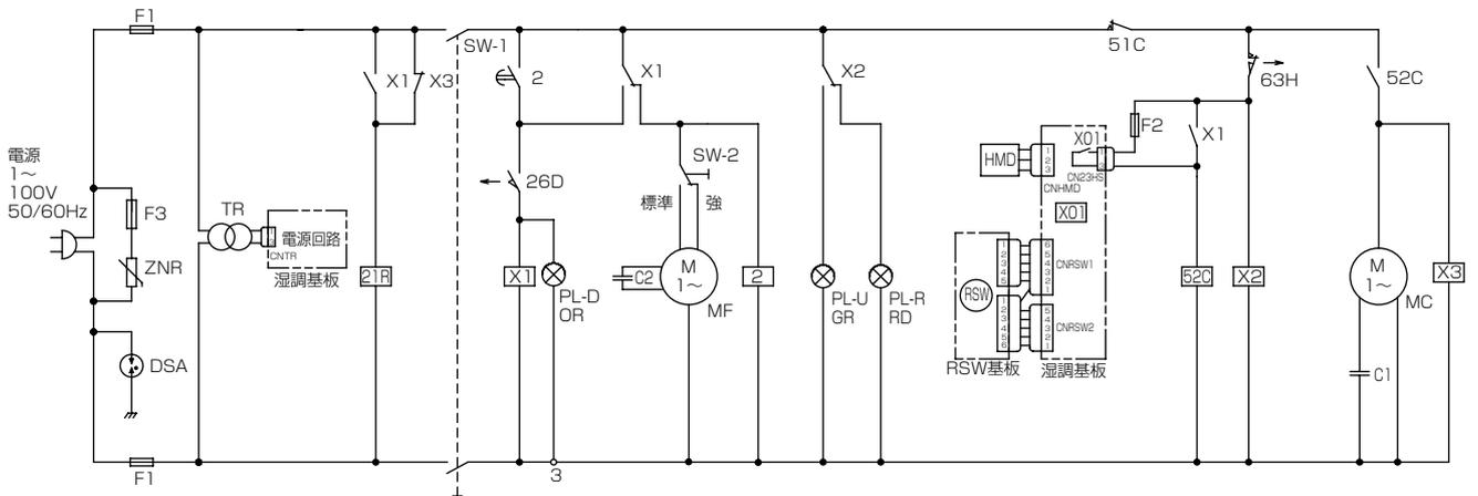
注1. 接点の矢印は、圧力・温度が上昇した時の接点動作方向を示します。
