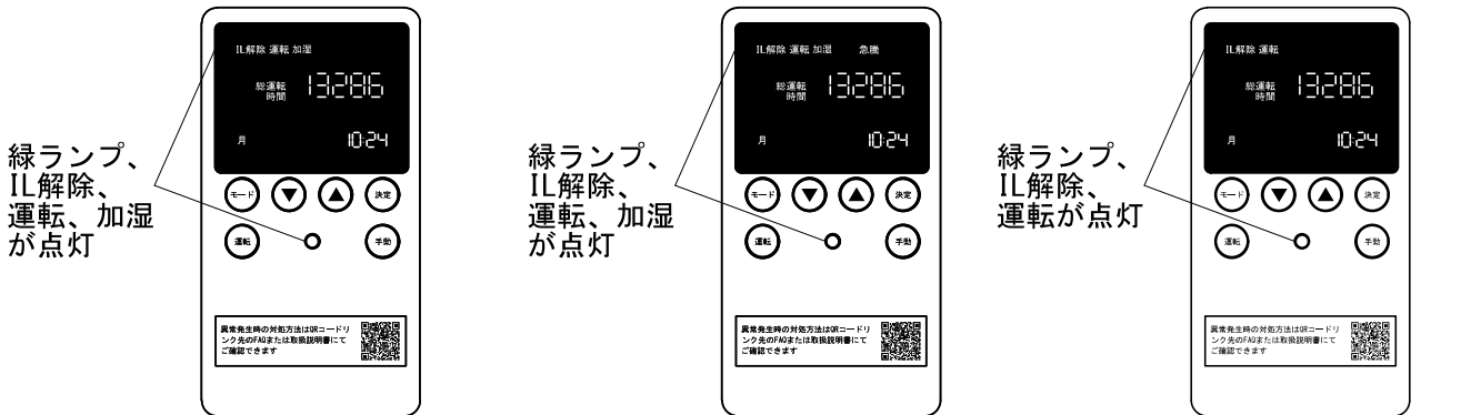
〈緑ランプ・IL解除・運転・加湿表示が点灯〉
